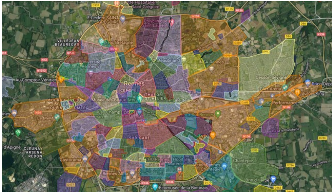
Figure 3 : Carte des polygones tracés pour la ville de Rennes (France). Chaque polygone de couleur représente une partie de la ville dans laquelle on retrouve une relative uniformité dans la hauteur des lampadaires.
